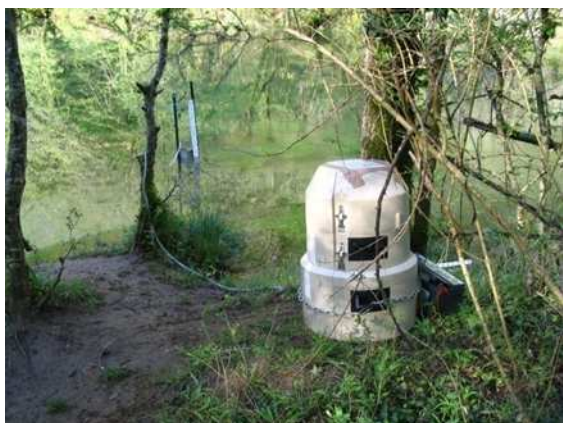
Photo 3 : Lors de traçages, un préleveur automatique permet de récupérer des échantillons d'eau à intervalles réguliers. L'analyse en laboratoire permettra de détecter puis de doser le traceur éventuellement présent même s'il demeure invisible à l'œil nu.
