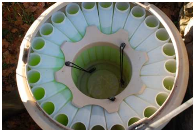
Photo 3 : Lors de traçages, un préleveur automatique permet de récupérer des échantillons d'eau à intervalles réguliers. L'analyse en laboratoire permettra de détecter puis de doser le traceur éventuellement présent même s'il demeure invisible à l'œil nu.
