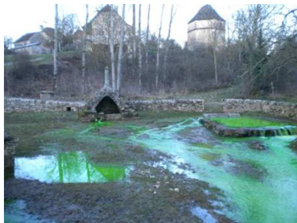
Photo 2 : A gauche : injection de fluorescéine à la perte de Boulière (Thégra). A droite : restitution visible de cette même fluorescéine à la source de Bonnefont (Mayrinhac-Lentour)
