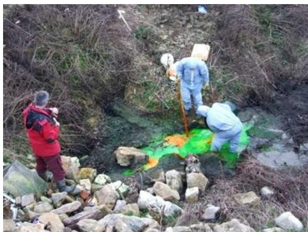
Photo 2 : A gauche : injection de fluorescéine à la perte de Boulière (Thégra). A droite : restitution visible de cette même fluorescéine à la source de Bonnefont (Mayrinhac-Lentour)
